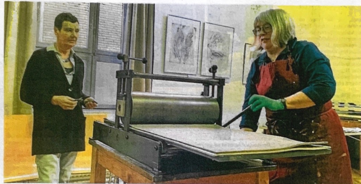
Unter hohem Druck wird das Papier über die vorher gefertigte Zinkplatte gekurbelt.
